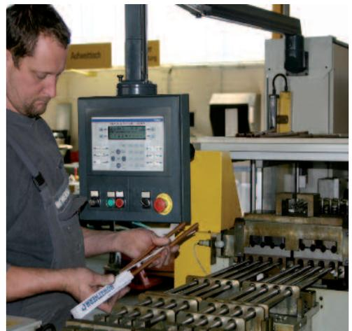
Rohrbiegemaschine für die WÜ-Fertigung
