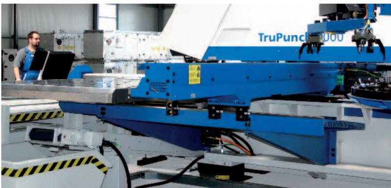
CNC-gesteuertes vollautomatisches Stanz-Zentrum
