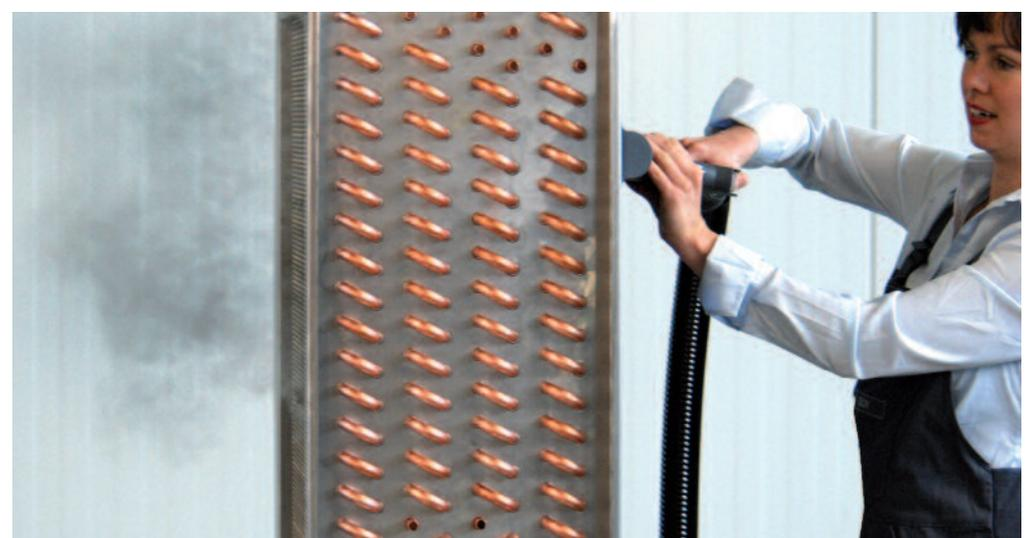
Hygienische und komfortable Reinigung mit dem System Vapo4clean
