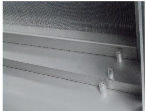
Positionierelemente aus Metall
