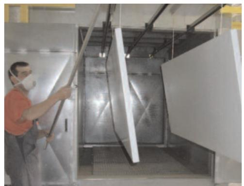
Pulverbeschichtung der Panelschalen und Komponenten bei 200°C
