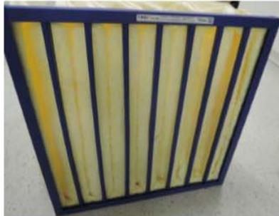
**Druckverlustanstieg durch Staubaufnahme**
